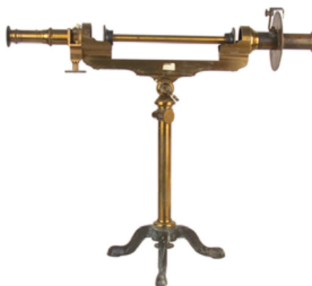
FIGURA 2. Sacarímetro de Soleil, perteneciente a la Colección de Física y Química del IES Francisco Ribalta (Castelló de la Plana). Ejemplares como este, o similares, son comunes en los gabinetes históricos de institutos y universidades en España.
